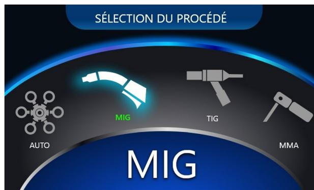
En mode manuel, l'utilisateur règle tous les paramètres les uns après les autres. Le système suggère les valeurs optimales par rapport à l'épaisseur de la pièce à souder. Cette information permet au soudeur de vérifier la justesse de ses réglages. Selon le style de soudure (en position, speed up à forte intensité, ou passe de racine à faible intensité) ces réglages demanderont des ajustements de la part de l'utilisateur.
