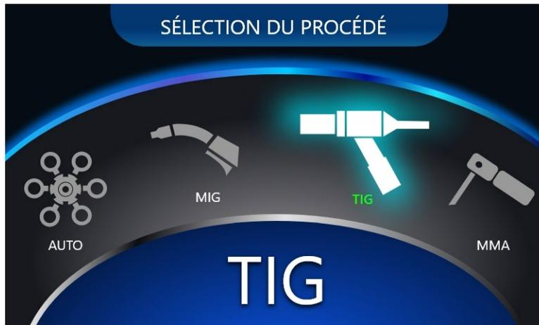
Dans le procédé TIG (Tungsten Inert Gas), l'amorçage de l'arc est effectué sous protection gazeuse inerte (Argon) entre la pièce à souder et une électrode non fusible en Tungstène pur ou allié avec des additifs.
