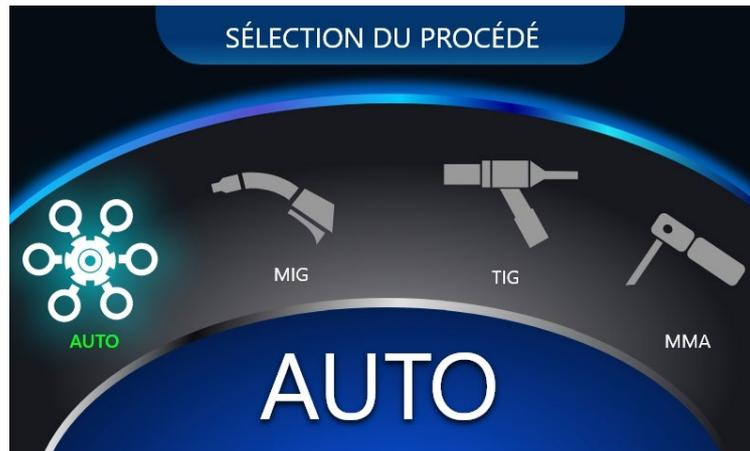
L'utilisateur sélectionne les paramètres de base du soudage tels que le matériaux, l'épaisseur de la pièce à souder et le diamètre de fil utilisé (0,8mm, 1,0mm et 1,2mm). Les autres paramètres seront automatiquement réglés selon la base de données interne de l'appareil.
